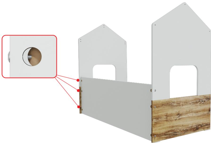
**Paso 2:** Colocar los tacos de madera en el larguero utilizando los tornillos autop. 4x40. Estos servirán luego de soporte para la parrilla.
