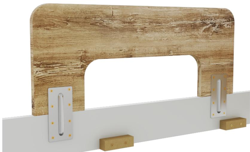
**Paso 6:** Finalmente colocar la parrilla y ajustar atornillando en los soportes centrales con tornillos 4x45 sobre los agujeros pasantes.
