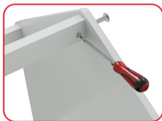
**Colocar la tuerca cilíndrica en el orificio de la viga y girar hasta que la rosca coincida con el tornillo allen, luego ajustar.**
