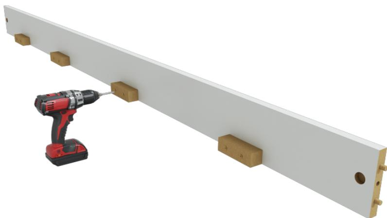
**Paso 3:** Colocar larguero utilizando tornillos 1/4x60 y ajustando tuercas cuadradas.
