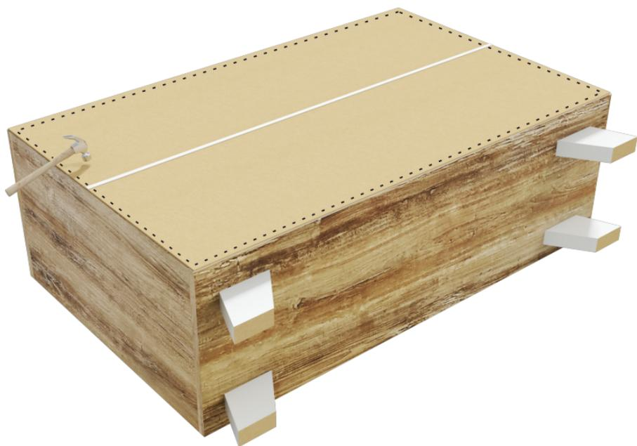
**Paso 6:** Identificar piezas de los cajones, colocar tarugos 6x25 y minifix de 12mm.
