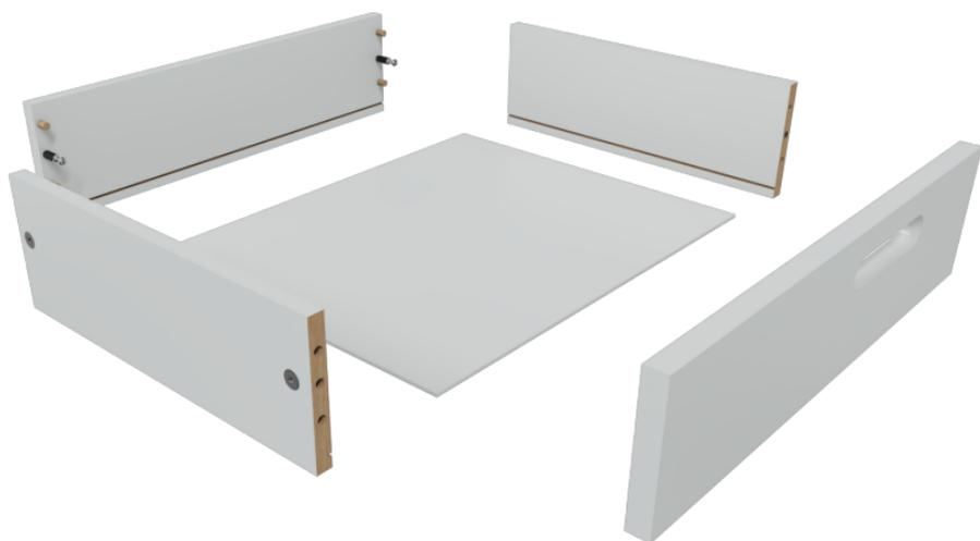
**Paso 7:** Unir primero ambos costados con el trasero de cajón y ajustar las cajas minifix. Luego deslizar el fondo por las ranuras. Colocar el frente y ajustar nuevamente.
