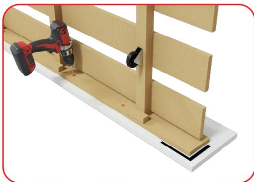
**Paso 2:** Una vez armado el carro deslizar por debajo de la cama como indica la figura.
