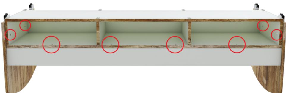
**Paso 4:** Por detrás atornillar los soportes metálicos, ajustando un extremo a la parrilla y el otro a la base de la cajonera.
