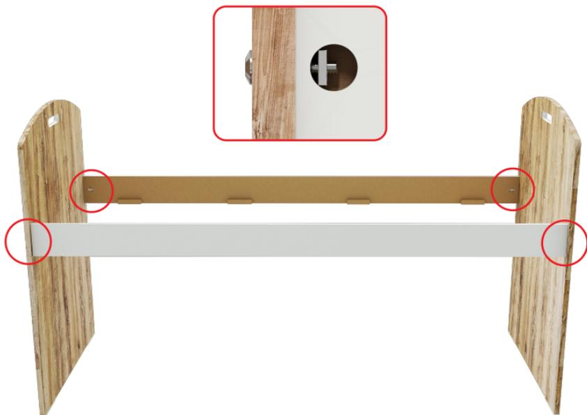
**Paso 2:** Colocar el soporte trasero y ajustar con tornillos allen y tuercas medialuna. Ubicar la tuercas como muestra la figura y pasar el tornillo.
