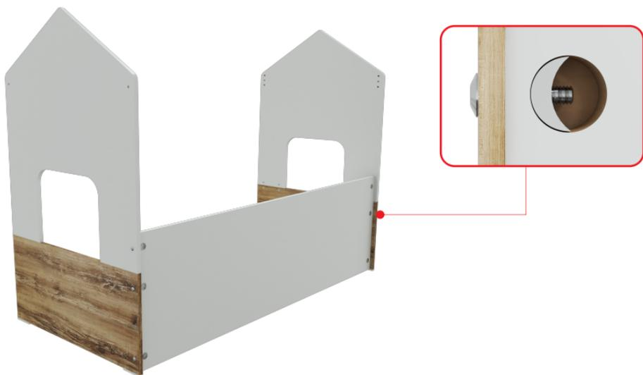
**Paso 2:** Colocar los tacos en el larguero ajustando con tornillos autop. 4x40. Luego ubicar el larguero inferior con tornillos allen y tuercas cuadradas.
