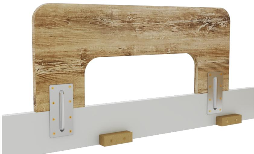
**Paso 5:** Ubicar las parrillas ajustando sobre los soportes centrales con tornillos 4x45 en los aguj. pasantes.
