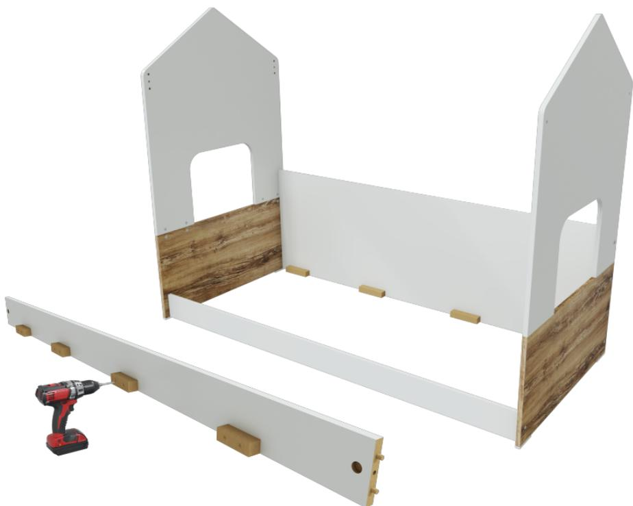
**Paso 3:** Atornillar los largueros superiores utilizando tornillos allen y tuercas cuadradas. Luego realizar un ajuste general para afirmar.
