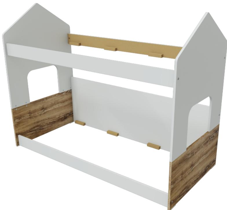
**Paso 4:** Colocar las barandas ajustando los soportes metálicos con los tornillos phillips autop. 3,5x16.
