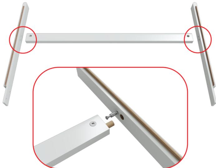
**Paso 4:** Atornillar el extremo inferior de la guía a los largueros apoyando sobre el respaldo alto. Utilizar tornillos 4 x 25.
