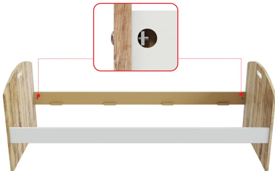
**Paso 2:** colocar soporte trasero con tarugos y tornillos allen, ajustando con tuercas cuadradas.
